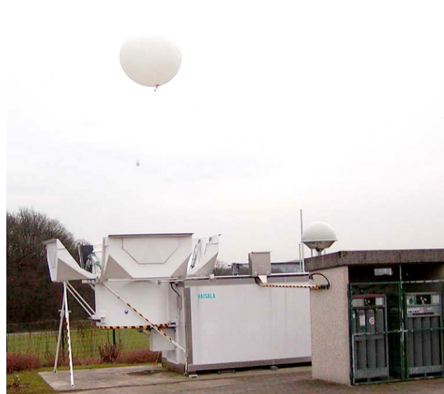
Station der Firma VAISALA zum vollautomatischen Start von Wetterballons www.vaisala.com
